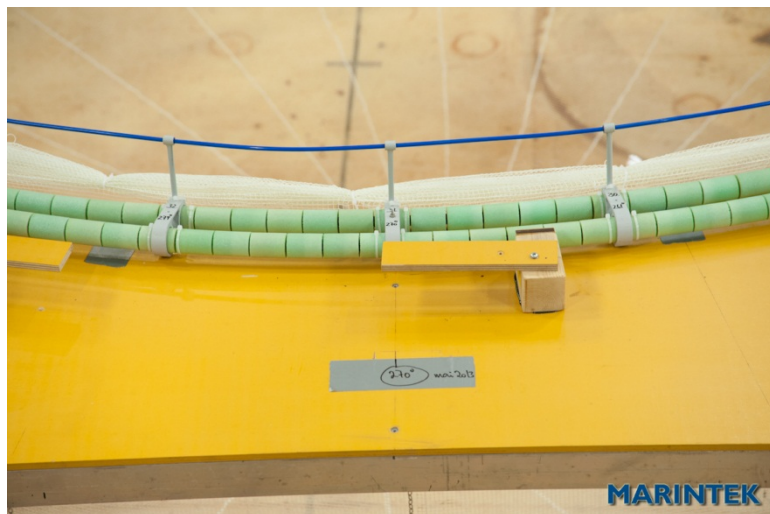
Figur 3.4: Detalj av flyteringen. Dobbelt 450 mm-rør.
