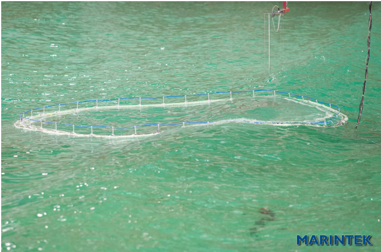
Foto 6: T3140, H_s = 4.0 m, T_p = 8 s, V_c = 0.7 m/s, 50 kg/m bunnring, 200 kg bunnlodd. Oppsett A.
