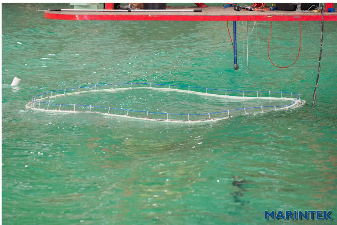
Foto 7: T5140, H_s = 4.0 m, T_p = 8 s, V_c = 0.7 m/s, 50 kg/m bunnring, 200 kg bunnlodd. Oppsett C.
